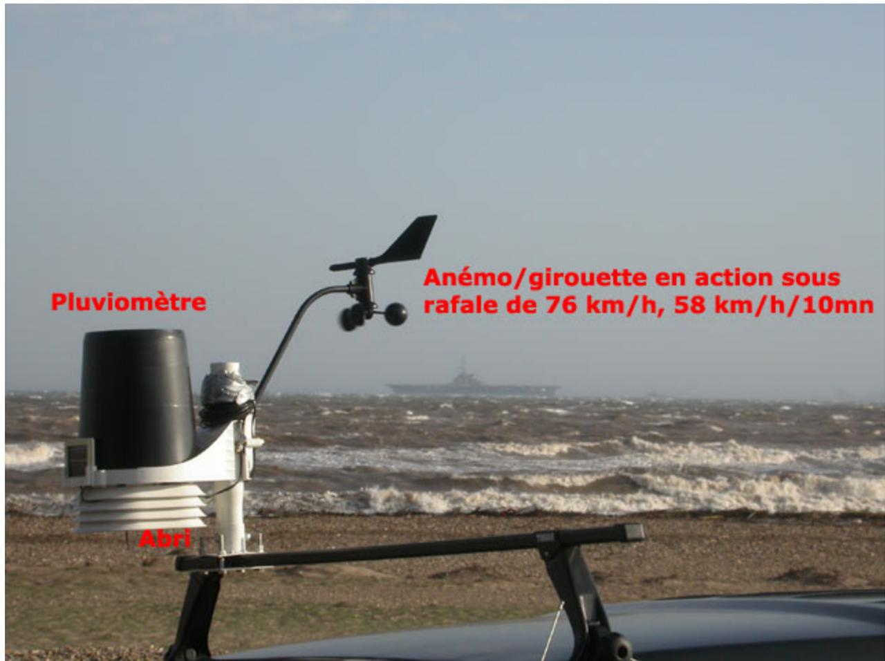
L'installation des capteurs est très rapide par rapport à la Monitor2, si un tube de diamètre 32 à 44 mm est déjà positionné. En se procurant des U plus larges, on peut la fixer sur un tube de 64 mm maxi (ici des U de fixation de pots d'échappement de Norauto sur un tube de 50 mm).
