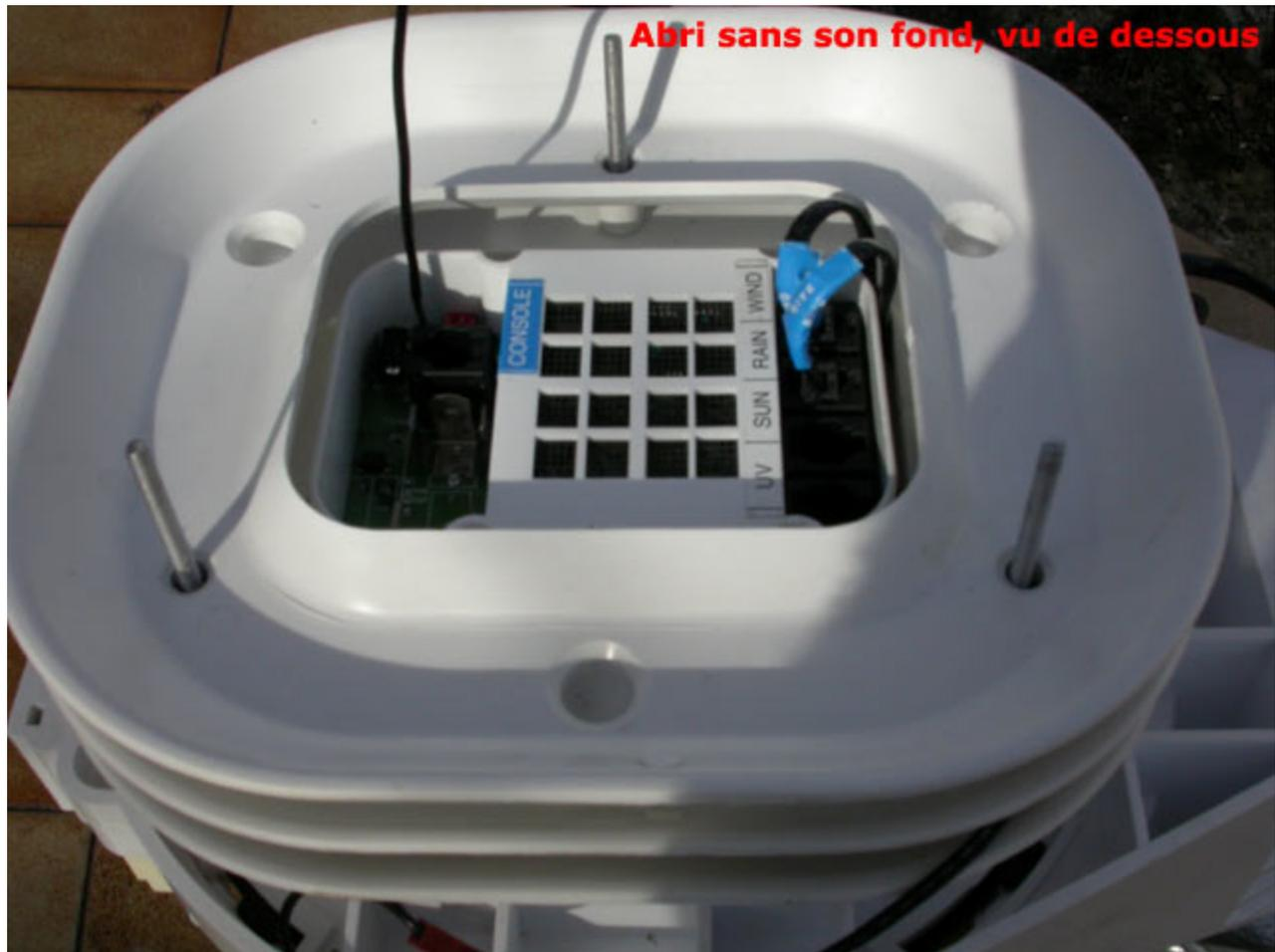
Tous les autres capteurs sont déjà branchés sur la carte électronique (la version fil est livrée avec 30 m de câble, extensible à 300 m). Une vérification du serrage des divers boulons des capteurs, solaire et d'UV, est nécessaire.
