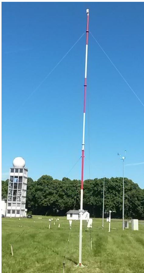
Figure 6-7 : mât et accéléromètre à son sommet pour un test de la mesure des mouvements au sommet du mât
