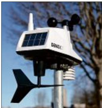
Voilà un exemple de station permettant de collecter et transmettre les données météo.
